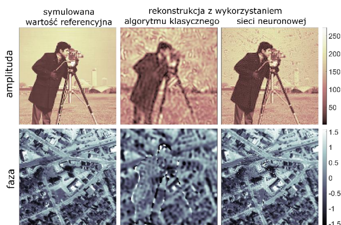
Rysunek 1: Porównanie klasycznej metody opartej o optymalizację gradientu i konwolucyjnej sieci neuronowej do rekonstrukcji danych dla ptychografii Fourierowskiej.
