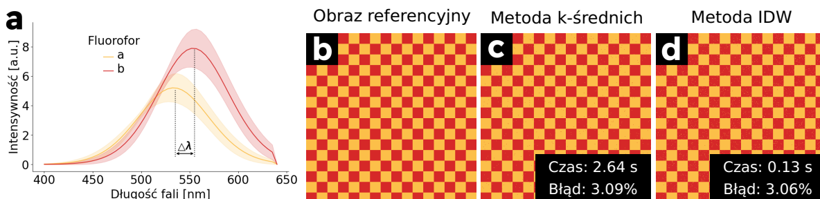
Rysunek 1: Dane syntetyczne i porównanie metod klasteryzacji (a) przykładowe widma optyczne wygenerowanych fluoroforów, (b) syntetyczny obraz referencyjny, (c) wynik klasteryzacji metodą k-średnich, (d) oraz metodą IDW
